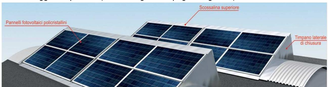
I pannelli saranno montati orizzontalmente con una fila per ogni shed con la possibilità di raddoppiare le file dei pannelli e quindi la potenza dell'impianto.
